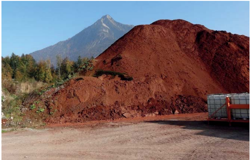
Zwischenlager phosphorhaltiger Klärschlammasche in der Reaktordeponie Cholwald (NW).
