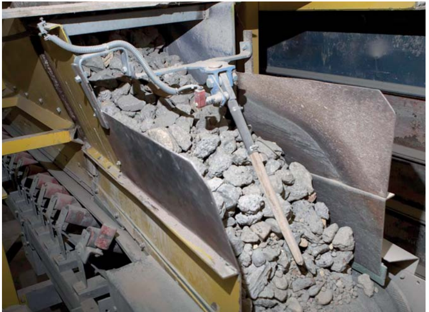
Betonabbruch wird zu Betongranulat aufbereitet.
