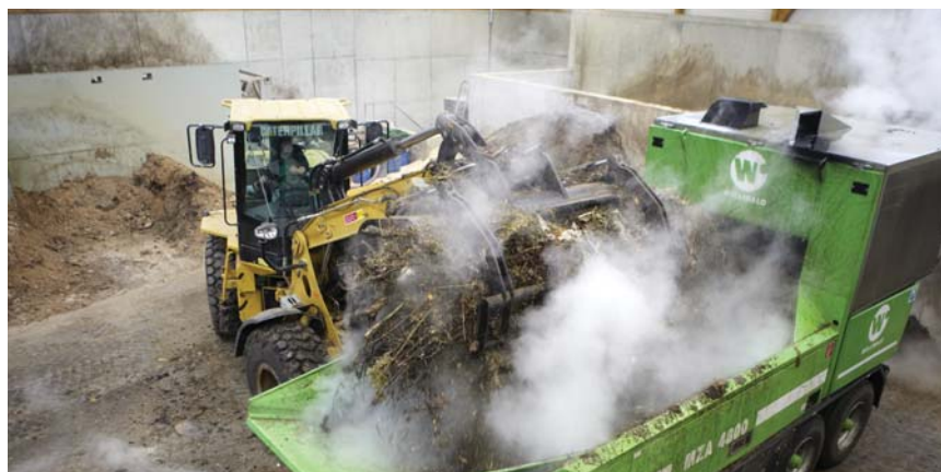
Im Schredder wird die Abfall-Biomasse für die Kompostierung aufbereitet. Foto: BAFU/AURA, E. Ammon
