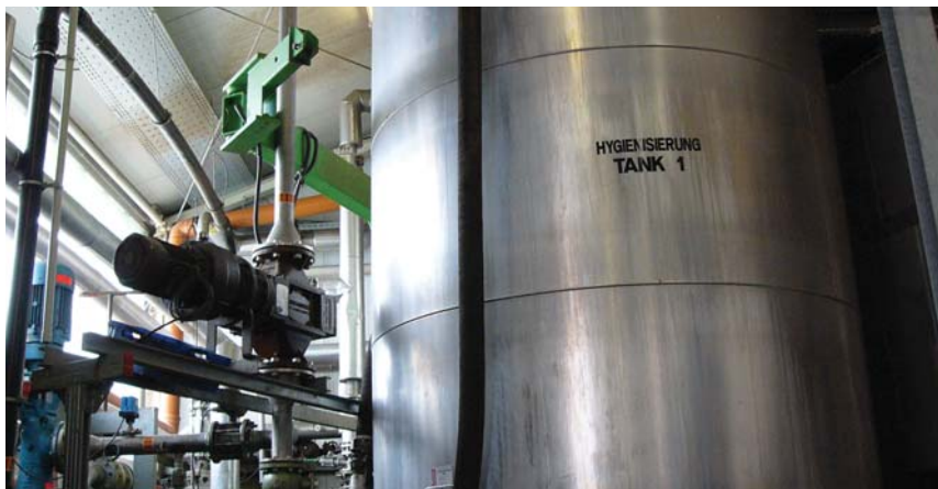
Speisereste gewerblicher Herkunft dürfen nicht mehr den Schweinen verfüttert werden. Die Vergärung ist ein alternativer Entsorgungsweg. Aus Gründen der Seuchenprävention müssen Speiseabfälle hygienisiert werden.
