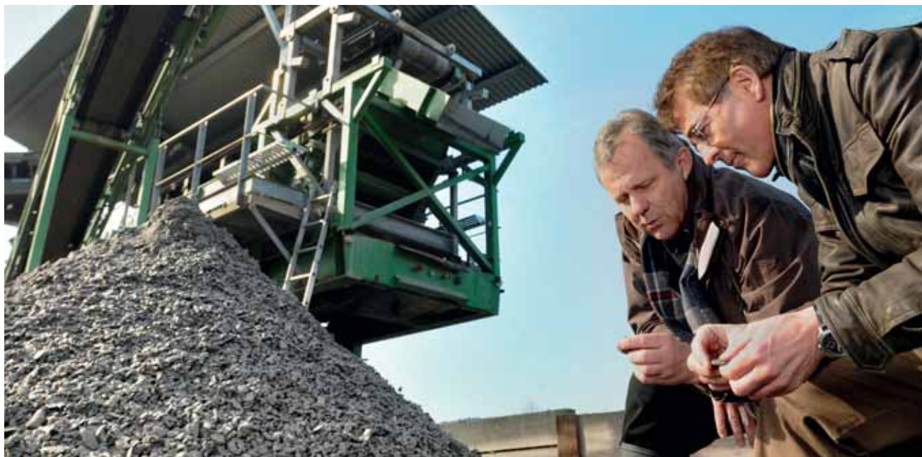
Aus 25'400 Tonnen Kehrichtschlacke wurden im vergangenen Jahr 2'400 Tonnen verwertbares Eisen und Nichteisenschrott entnommen. (Bild: uwe-Mitarbeiter Robert Schnyder (r) und Franz Fischer vom Abfall-Gemeindeverband vor der Schlackensortieranlage Oberbürlimoo, Rothenburg) Foto: Dominik Hodel
