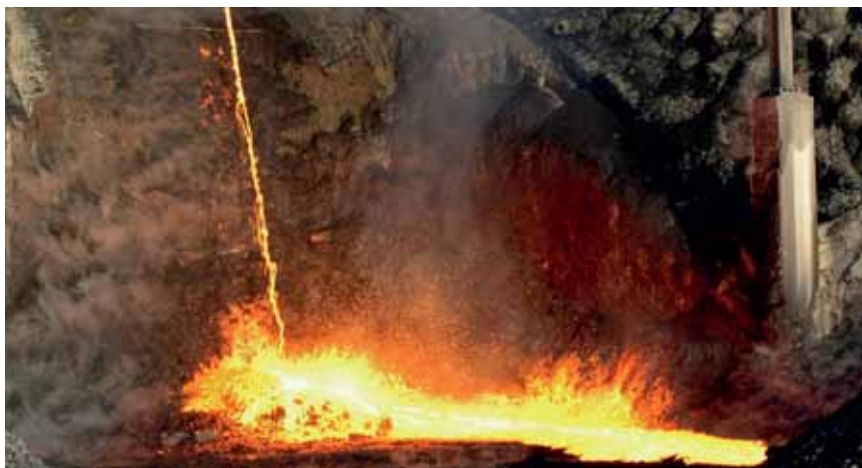
Die Schmelzpfanne mit flüssiger Elektroofenschlacke (EOS) wird entleert. Aufbereitete EOS wird als Kiesersatz verwendet. Foto: Esther Nicollier
