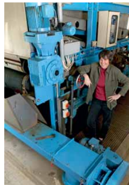
Klärschlammpresse ARA Rontal. Der ausgefaulte Klärschlamm wird gepresst und zur Schlammverbrennung nach Emmen gefahren (im Bild: Cornelia Crespi, uwe).
